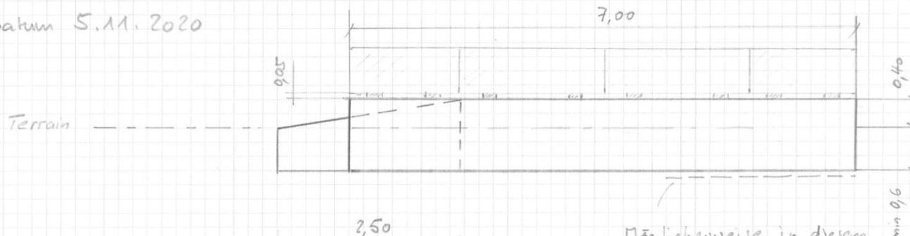
Möglicheweise in diesem Bereich das Fundament tiefer setzen wegen Geländevolant.
